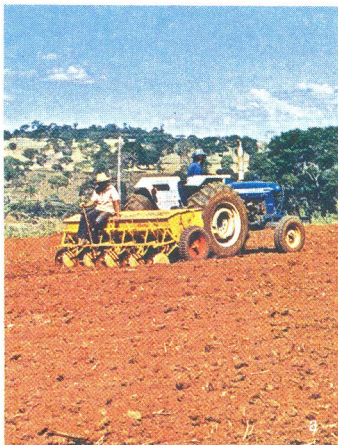
FIGURA 2 – (a) Plantio de lavoura de feijão com equipamento para incorporação profunda do adubo; (b) Distribuição profunda do adubo no solo.
