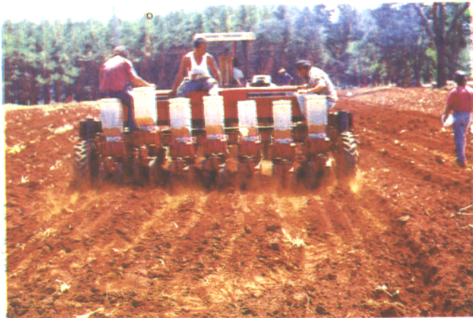
FIG. 12. Máquina para adubação profunda.
