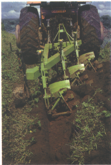
FIG. 2. Aração profunda com arado de aiveca.
