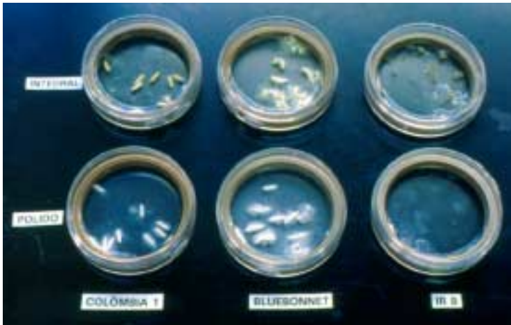
Fig. 4. Resultado da variação da temperatura de gelatinização em arroz polido e integral, usando-se o mesmo procedimento de rotina.
