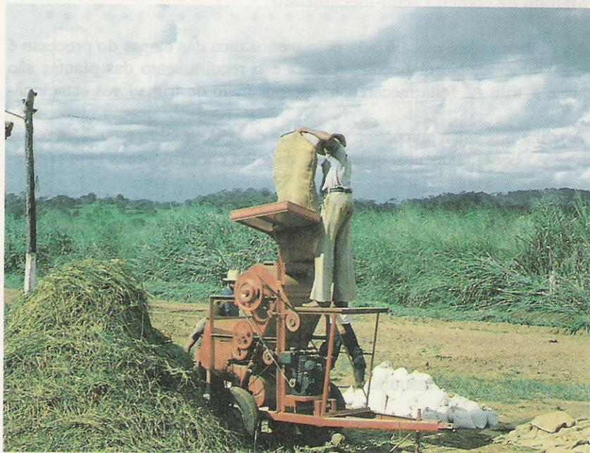
**FIG. 3** Trilhadora de arroz estacionária de alimentação contínua.
