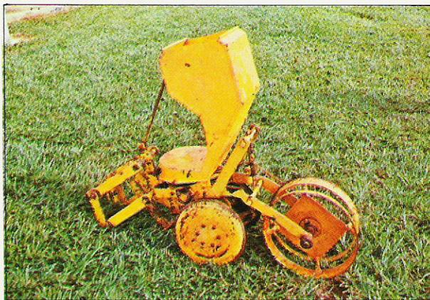
FIGURA 4. Mecanismo semeador de milho para acoplamento em semeadeiras de feijão
