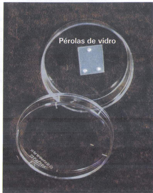
Foto 2. Olfatômetro (arena com pérolas de vidro simulando os ovos de percevejo) utilizado para avaliar a resposta à curta distância do parasitóide Telenomus podisi ao feromônio de alarme de Piezodorus guildinii .
