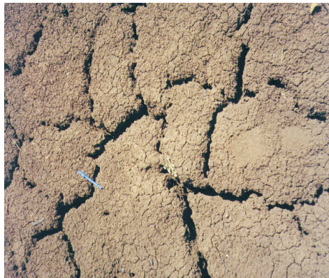
Fig. 23. Fendilhamento em superfície de Vertissolo.
