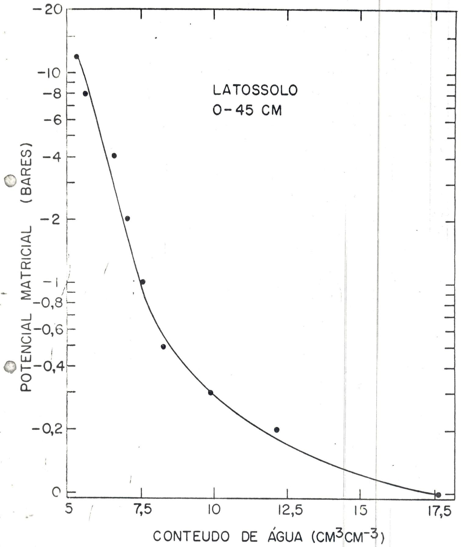
Figura 1. Curva de retenção de água para a camada de 0-45 cm do Latossolo.
