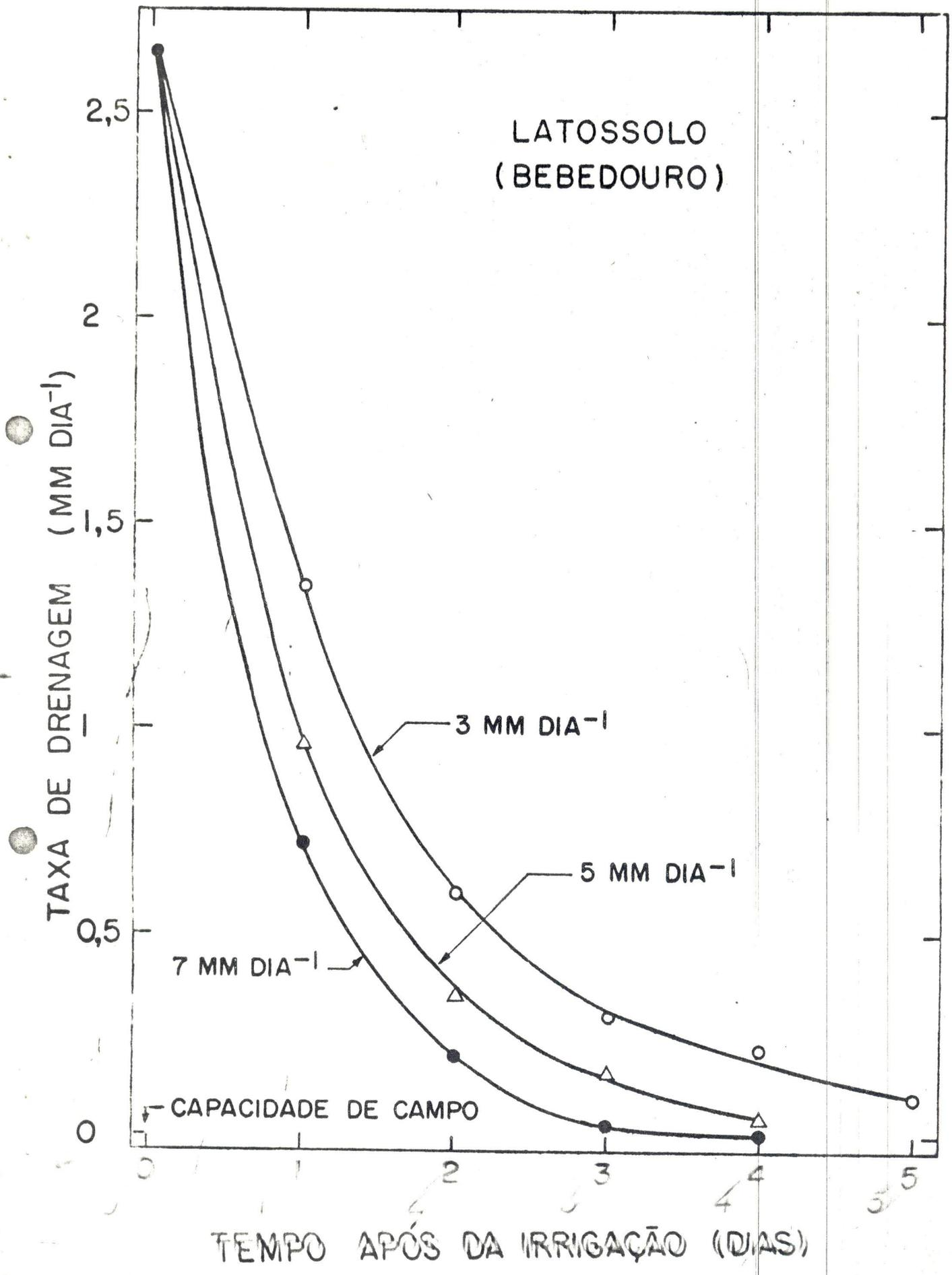
Figura 8. Taxa de drenagem em função do tempo após a irrigação, para diferentes padrões de extração de água.
