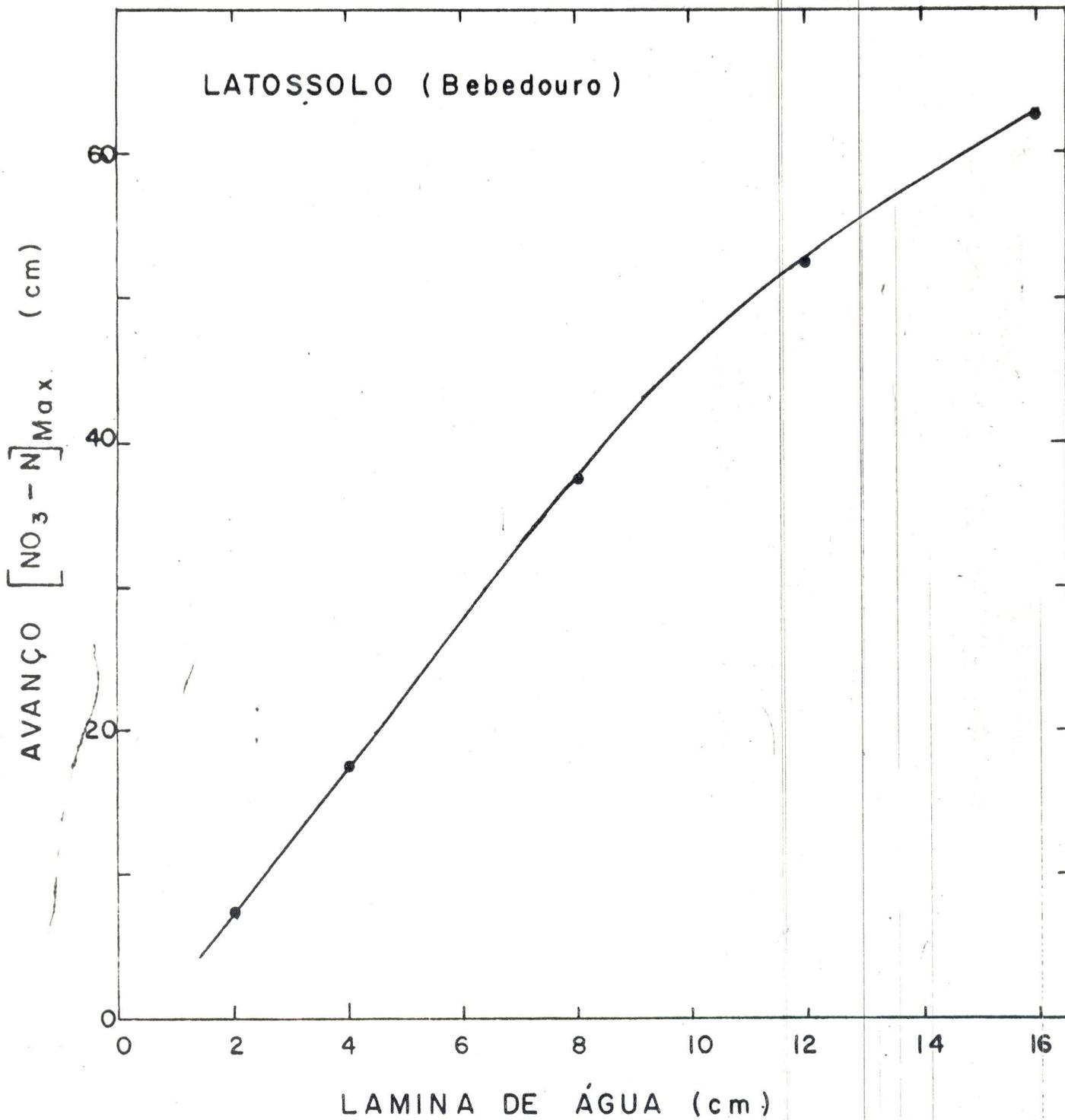
Figura 6. Relação entre o avanço da concentração máxima de nitrato e a lâmina de água aplicada.
