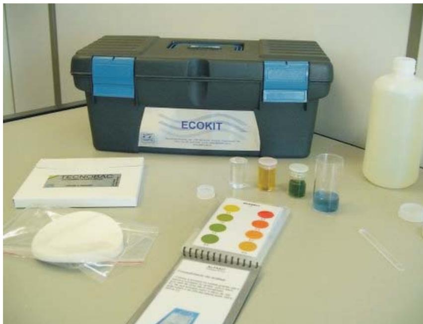
**Fig 1.** EcoKit® para determinação da qualidade de água.
