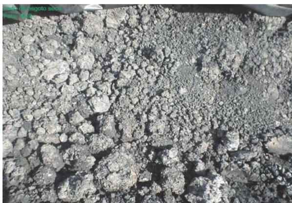
Fig. 1. Aspecto do lodo de esgoto seco.
