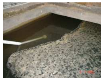
Fig 10: coloração da água 40hs após adição do sulfato de alumínio com a cisterna cheia (ocorrência de chuva neste período)
