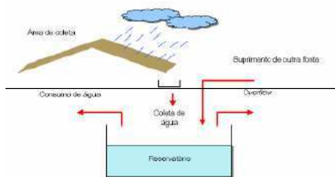
Figura 2- Esquema de aproveitamento de água de chuva
