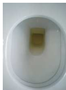
Fig 12: coloração da água de chuva nos pontos de consumo após tratamento com sulfato de alumínio
