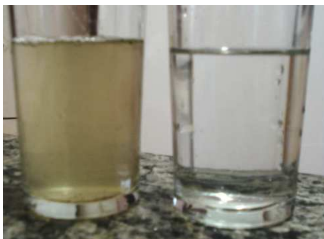
Figura 3 – Cor da água pluvial captada inicial e após a ocorrência de 30 minutos de chuva
