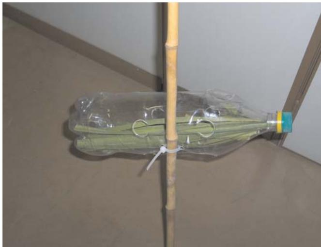
Fig. 1. Modelo do coletor com substrato artificial.
