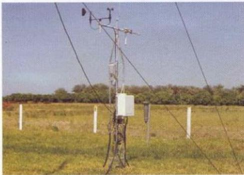
Estação Agrometeorológica Automática instalada na Embrapa Semi-Árido, Petrolina - PE.
