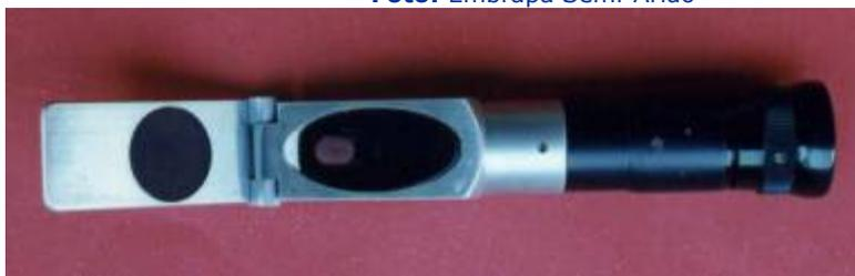
**Fig. 1** – Refratômetro manual.
