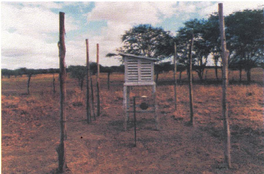
Fig. 1. Foto do abrigo meteorológico e do globo negro.
