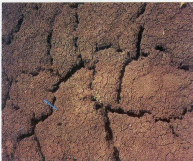
Fig. 3. Rachaduras provenientes de ciclos de umedecimento e secagem
