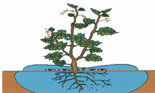
Fig. 28. Comportamento do volume de solo molhado e a distribuição do sistema radicular da planta sob irrigação por microaspersão.
