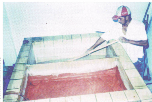
Fig. 37. Tanques para dissolução de fertilizantes, usados como acessórios dos equipamentos de fertirrigação.
