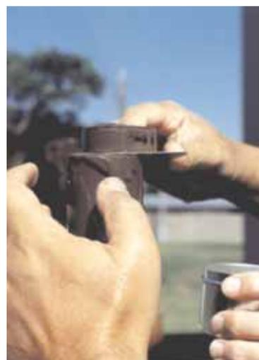
**Fig. 8.** Detalhe do corte (segmentação) das amostras de sedimento de um viveiro de piscicultura em Pirassunga, SP.
