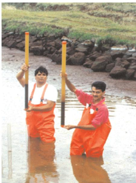
**Fig. 6.** Detalhe dos tubos de PVC com as amostras de sedimento de um viveiro de piscicultura em Chapecó, SC.
