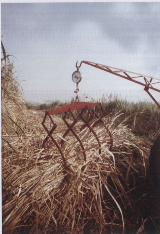
Fig. 40. Dinamômetro utilizado para determinar o peso de uma parcela experimental de cana-de-açúcar.
