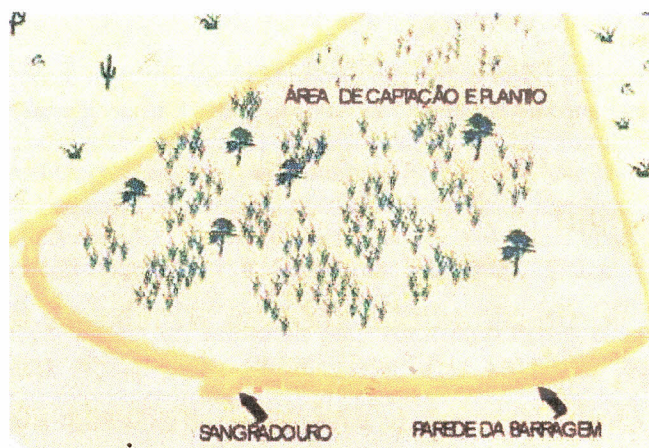
Figs. 79 e 80. Esquema de funcionamento de uma barragem subterrânea: à esquerda, vista transversal; e a direita, vista aérea (Silva et al , 2001).
