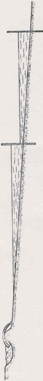
FIG. 2. Represamento da água em dois trechos ao longo do sulco, proporcionado pelo vertedor triangular para sulcos com declividade de 0,30%.
