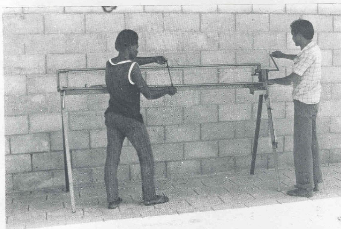
FIG. 9. Máquina em operação afrouxando o balancim.
