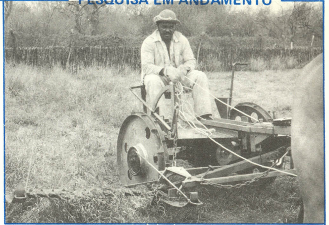
FIGURA 2. Lâmina de corte em posição de giro.
