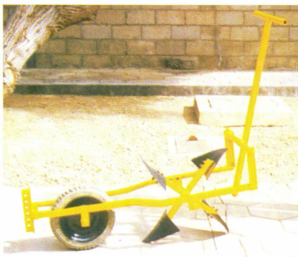
Fig. 1. Barrador de sulcos em condições de trabalho.
