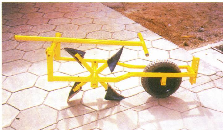
Fig. 2. Barrador de sulco em condições de transporte.
