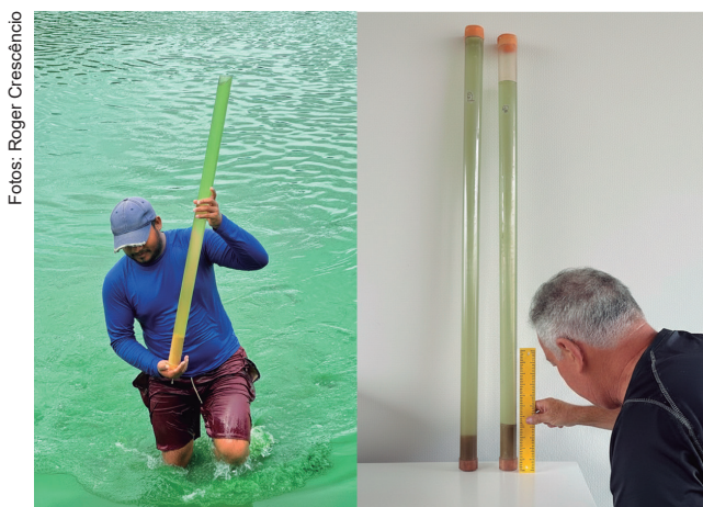
Figura 4. Verificação da altura da camada de matéria orgânica sedimentada no fundo do viveiro utilizando tubo de coleta de solo tipo liner .
