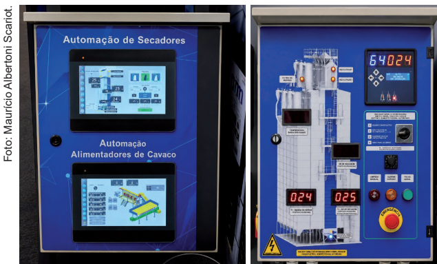
Figura 13. Sistemas automatizados para monitoramento do processo de secagem de grãos.
