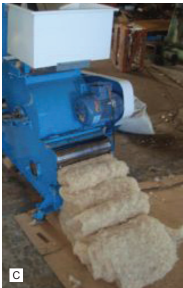
Figura 3. Detalhe do descaroçador e seu funcionamento: (A) câmara do descaroçamento com as serras e as costelas; (B) abastecimento do equipamento com a saída do caroço na parte da frente; (C) detalhe da saída da fibra em forma de manta; (D) abastecimento da prensa enfardadeira com a fibra.
