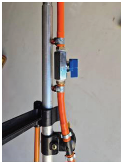
Figura 9. Detalhe da miniválvula com macho colocado na barra para permitir, ou não, a passagem da calda. (Embrapa).
