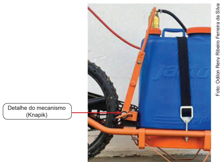
Figura 2. Detalhe do mecanismo de acionamento da bomba de pressão — coroa, corrente, pinhão, mecanismo de regulação e haste (Knapik).
