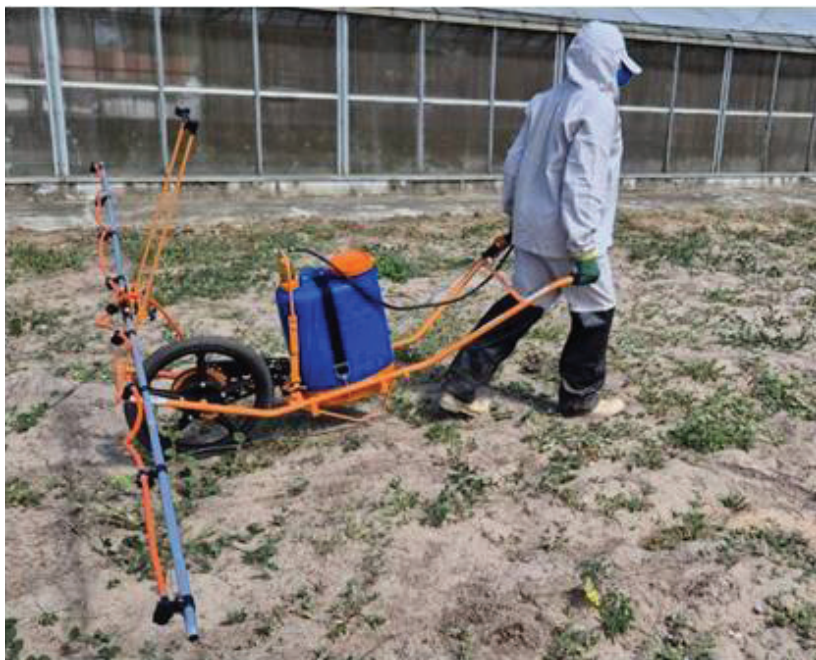
Figura 1. Pulverizador costal manual adaptado a uma carriola, no qual a força da roda aciona a bomba de pressão da calda (adaptação Knapik).
