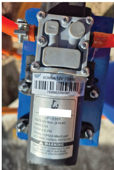
Figura 5. Detalhe das bombas de diafragma para misturar a calda destinada à pulverização (Embrapa).
