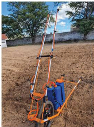
Figura 8. Detalhe da barra de oito bicos de pulverização, em que foram colocados dois registros interruptores (Embrapa).
