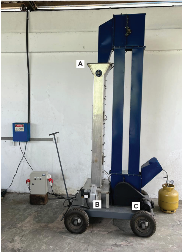
Figura 2. Vista lateral esquerda do flambador. Detalhes: (A) moega da câmara de combustão (B) ventilador; (C) motor elétrico trifásico 2 CV.
