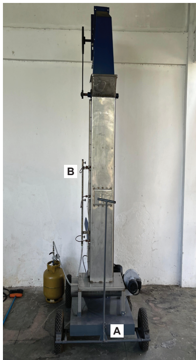
Figura 3. Vista frontal do flambador. Detalhes: (A) Chassi com quatro rodas pneumáticas; (B) Sistema de gás com três queimadores.
