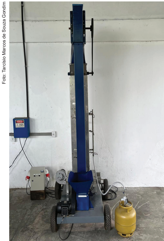
Figura 4. Vista posterior do flambador. Detalhe: (A) ligação trifásica entre a caixa de comando e a energia externa.
