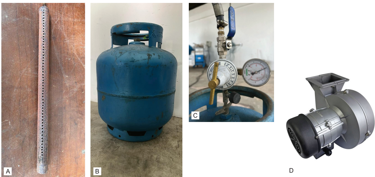
Figura 9. Detalhes dos componentes: (A) queimador confeccionado em tubo de cobre de 19,1 mm de diâmetro com orifícios de 1,6 mm diâmetro; (B) botijão de gás butano utilizado para abastecer os queimadores de gás; (C) registro ligado ao botijão, válvula reguladora da pressão e registro de esfera para o fechamento geral; (D) Ventilador para fluxo de ar com motor trifásico 220/380 v, Varivelox 1/3 CV a 3.500 rpm, vazão aproximada 12 m 3 /minuto e pressão aproximada 20 mmCA.
