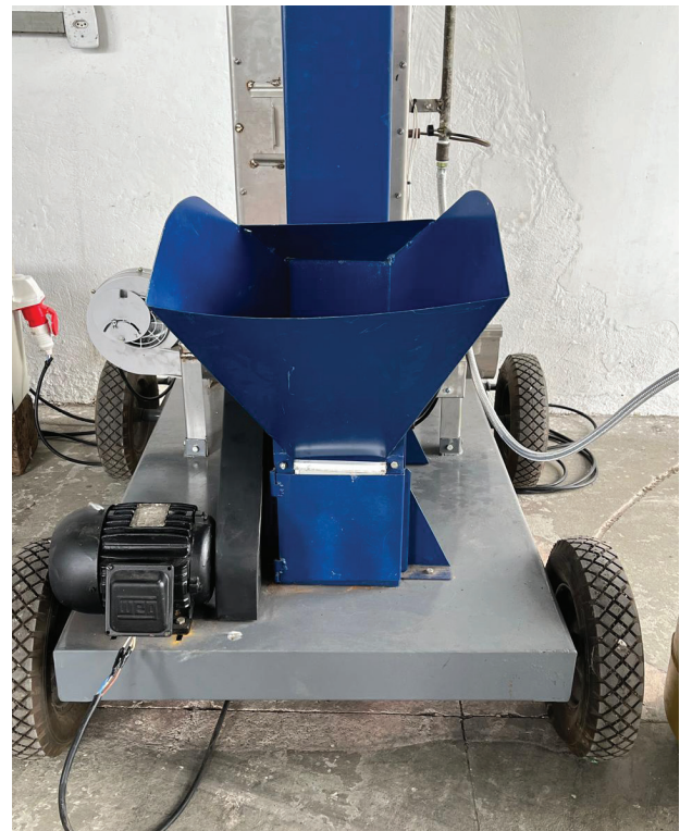
Figura 5. Detalhe do chassi e moega de abastecimento e motor elétrico.
