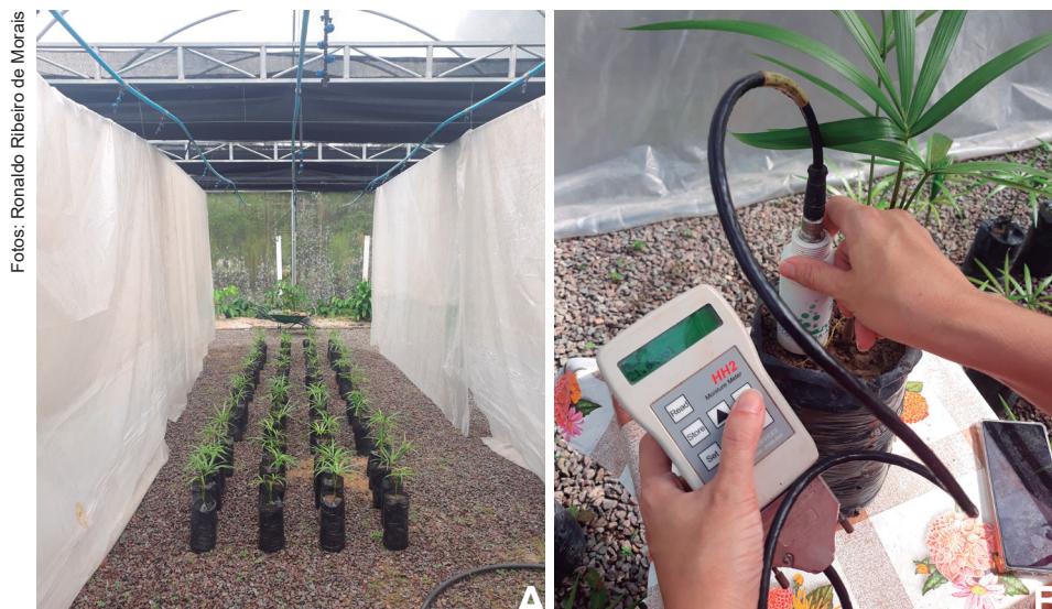
Figura 1. (A) Visão geral do experimento conduzido em casa de vegetação; (B) reflectômetro no domínio do tempo (TDR) utilizado para a determinação do teor de umidade do substrato em mudas de Euterpe precatoria .
