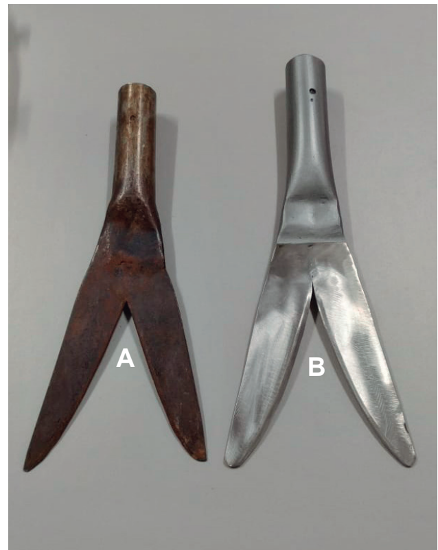
Figura 3. Ferramentas rabo de jaraqui, confeccionadas com sucatas de lâminas de roçadeira costal (A) e retalho de lâmina de ferro (B).
