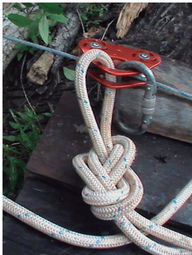
Figura 14. Polia dupla rolamentada e corda de apoio para controle da carga.
