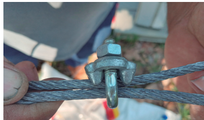
Figura 4. Maneira correta para encaixar o clip ao cabo de aço.
