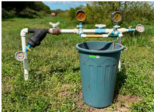
Figura 3. Injetor do tipo enturi ¾" (peça verde) sem pressurização adicional.
