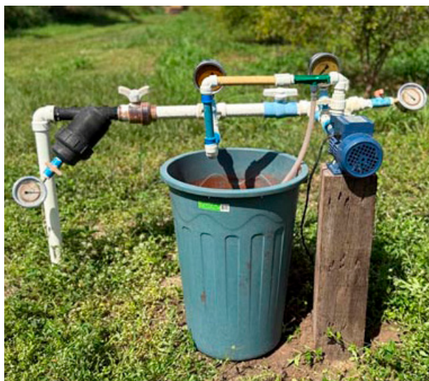
Figura 4. Injetor do tipo venturi ¾" com pressurização adicional (eletrobomba azul).
