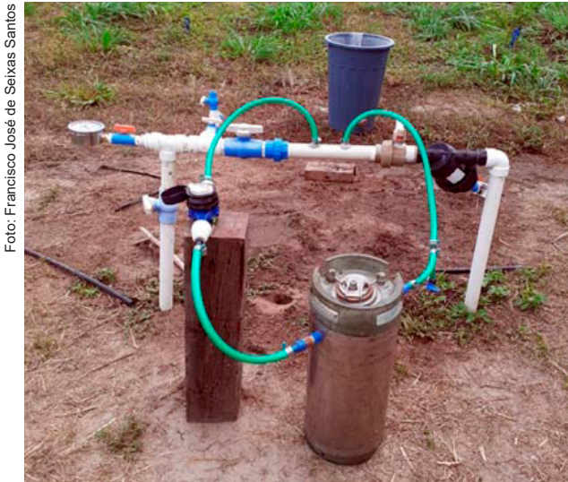
Figura 5. Injetor com tubos de pitot e tanque hermeticamente fechado.
