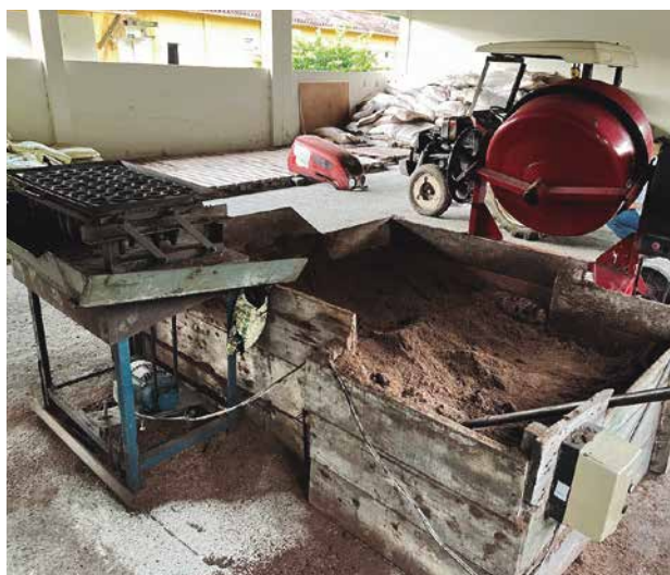
Figura 7. Equipamento tipo betoneira para mistura de todos os componentes do substrato e a água; caixa de deposição do substrato misturado e mesa agitadora para enchimento de tubetes. Instituto Biofábrica da Bahia.
