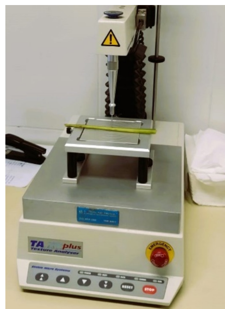
Figura 8. (A) Colorímetro usado para medir a cor das folhas (B) Texturômetro usado para determinar a dureza do colmo.
