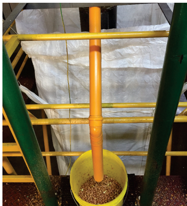
Figura 13.15. Exemplo de amostragem automática de amendoim para análise do teor de aflatoxinas ao final do beneficiamento, durante o acondicionamento em big-bags .
