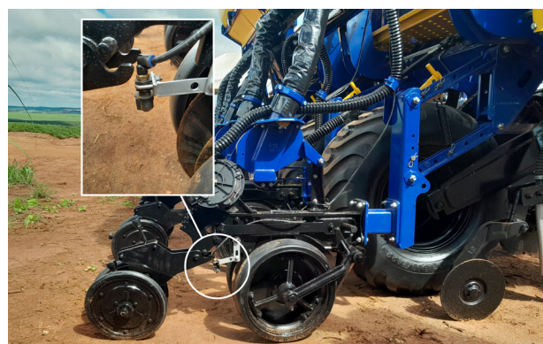
Figura 7.7. Detalhe do bico de pulverização acoplado à semeadora para pulverização no sulco de plantio.
