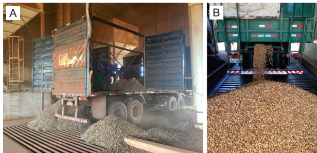
Figura 13.7. Carga de amendoim vinda do campo sendo descarregada na moega por gravidade com auxílio manual (A) e por esteira acoplada ao caminhão (B).
