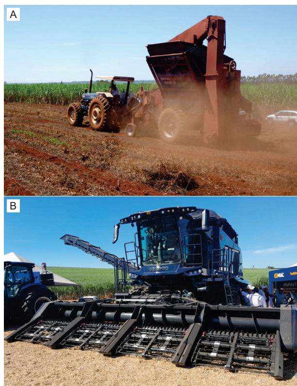
Figura 13.5. Equipamento acoplado ao trator (A) e automotriz para recolhimento e despencamento do amendoim (B).
