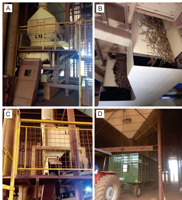
Figura 13.8. Processo de pré-limpeza mecanizada do amendoim antes da secagem: aspecto geral do equipamento (A), de partes de plantas sendo retiradas (B), compartimento com impurezas descartadas (C) e carregamento das carretas de secagem (D).
