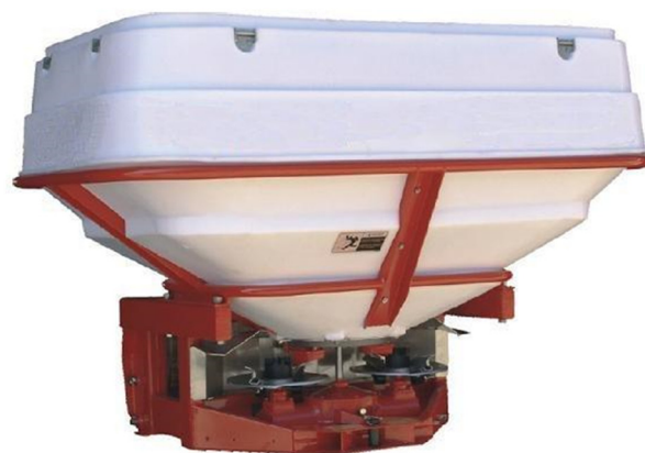
Figura 8.1. Distribuidor de fertilizante a lanço com dois discos horizontais.
