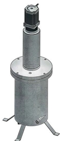
Figura 1. Desenho mecânico do reator de fermentação do tipo tambor agitado.
