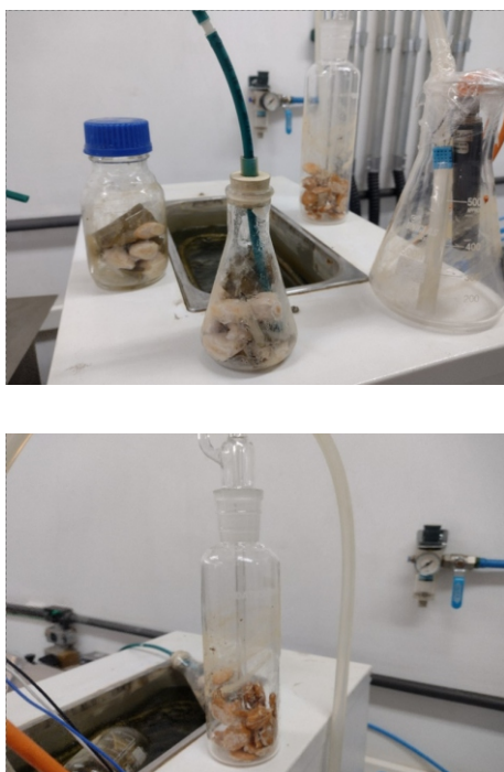
Figura 2. Acima, frascos de fermentação: à esquerda (tampa azul) vedado com cacau e folhas de bananeira (para simular fermentação natural em campo); Kitassato também com folhas de bananeira, porém com levedura e aeração; frasco lavador de gases com sementes de cacau; à direita, frasco Kitassato com sensores para medidas a umidade relativa do ar e concentração de \text{CO}_2 . Abaixo, detalhe do frasco lavador de gases com aeração no meio com sementes de cacau já fermentadas.
