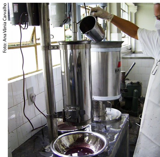
Figura 17.4. Despoldamento do açaí ( Euterpe oleracea Mart.).
