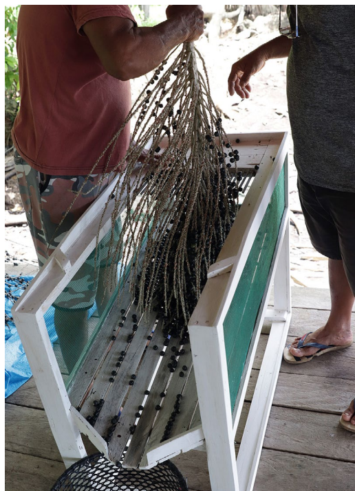
Figura 16.10. Debulhador, com separação de impurezas, invenção social de produtor.
