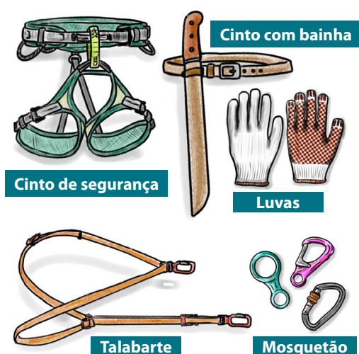
Figura 16.3. Kit de segurança para o apanhador de açai ( Euterpe oleracea Mart.).
