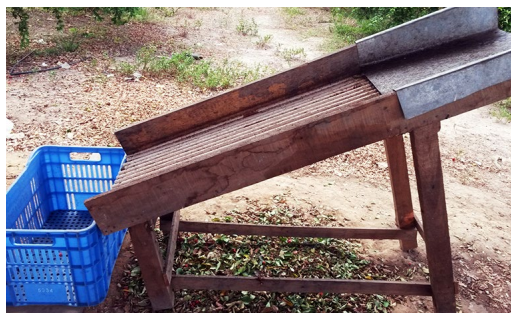
Figura 16.12. Separador de impurezas, invenção de produtor.
