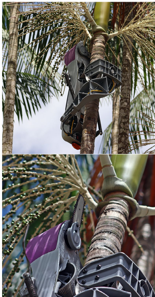
Figura 16.6. Equipamento de colheita de açaí ( Euterpe oleracea Mart.): AçaíBot.
