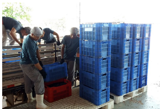
Figura 16.16. Base de polietileno, evitando o contato das caixas com o chão.
