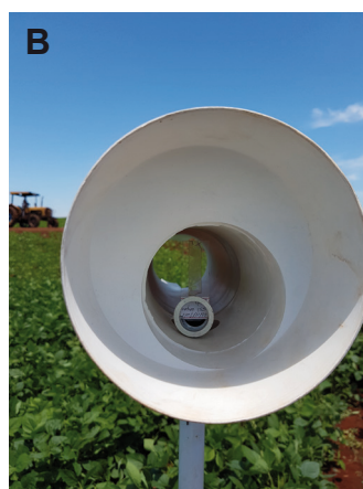
Figura 3. Visão geral do coletor de esporos na lavoura (A); tubo visto de frente mostrando o suporte com a lâmina de vidro acoplada (B); lâmina de vidro com a fita dupla face (com a proteção superior parcialmente retirada) (C).
