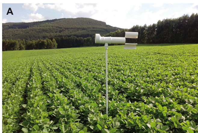
Figura 3. Visão geral do coletor de esporos na lavoura (A); tubo visto de frente mostrando o suporte com a lâmina de vidro acoplada (B); lâmina de vidro com a fita dupla face (com a proteção superior parcialmente retirada) (C).
