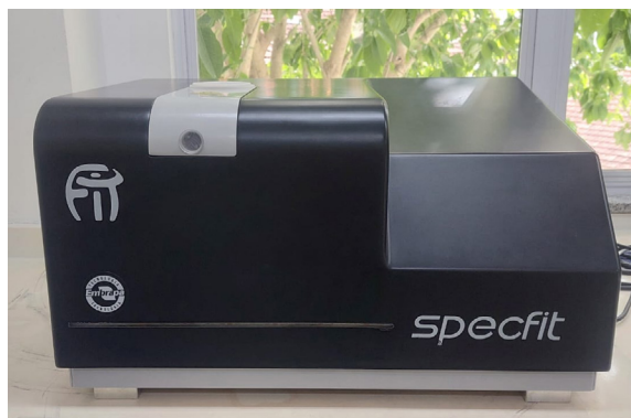
Figura 1. Equipamento de Ressonância Magnética Nuclear (RMN) em baixo campo com magneto permanente, modelo de bancada da SpecFit, utilizado para análises rápidas e não destrutivas em amostras diversas.
