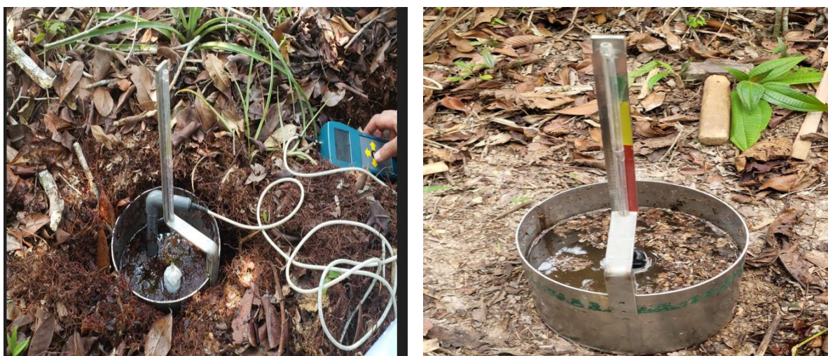
Figura 18.2. Determinação da taxa de infiltração básica (TIB) realizada com o infiltrômetro de anel simples ( single ring ) no Argissolo Amarelo Distrófico latossólico antrópico (AM-01).
