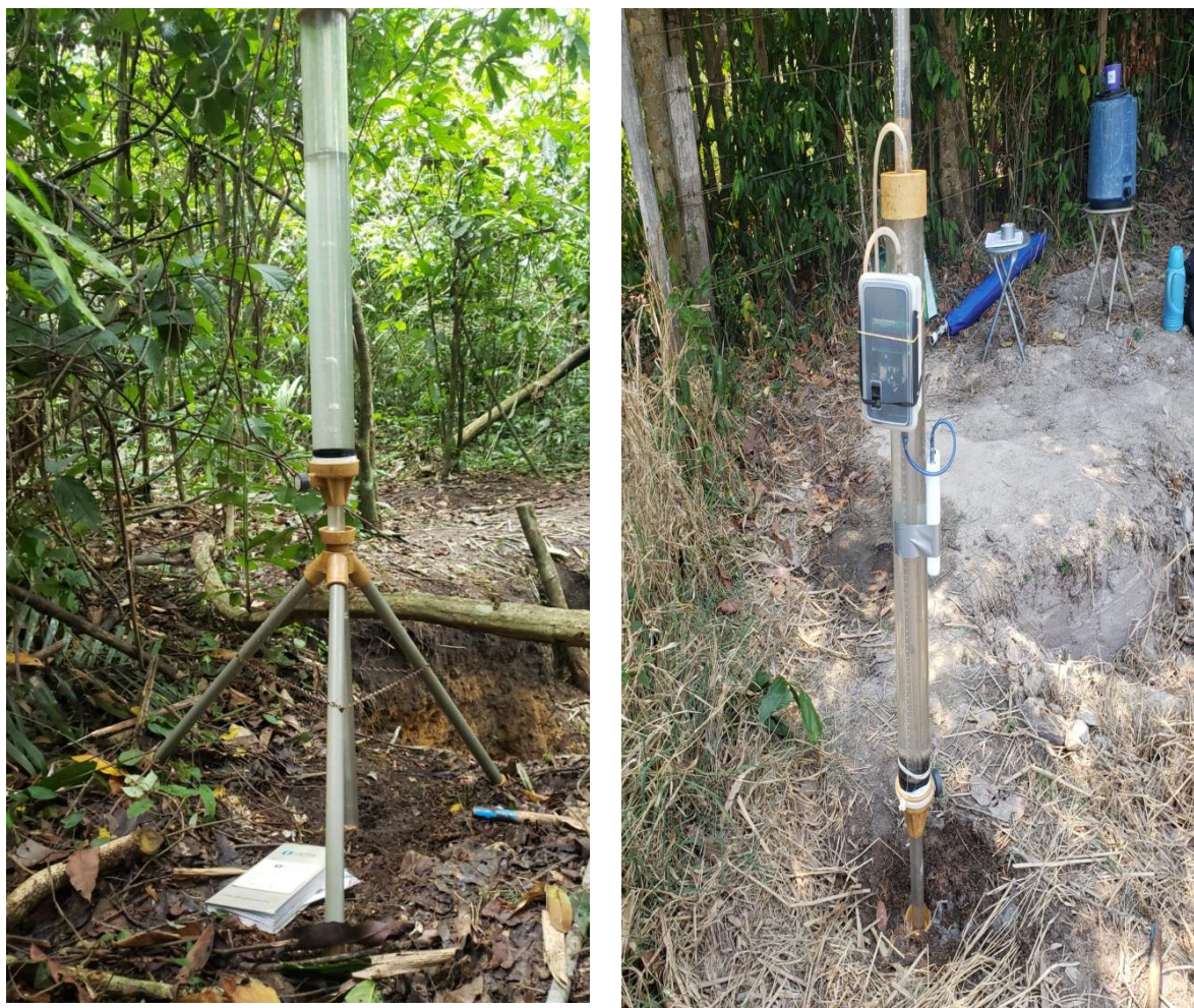
Figura 18.1. Permeâmetro de Guelph com o frasco de Mariotte, instalado no campo para a determinação da K_{fs} a 20 cm (horizonte A) e a 60 cm (horizonte B).
