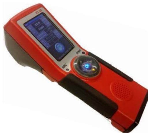
Figura 15.3. Susceptibilímetro magnético e condutivímetro - Modelo KT 20 S/C.
