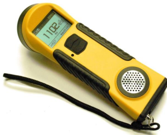
Figura 15.2. Susceptibilímetro magnético e condutivímetro - Modelo KT-10 v2.
