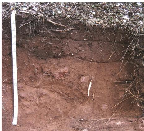
**Figura 15.** Perfil-2SN, Cambissolo Háplico pouco profundo com blocos rochosos na massa do solo e na superfície.
