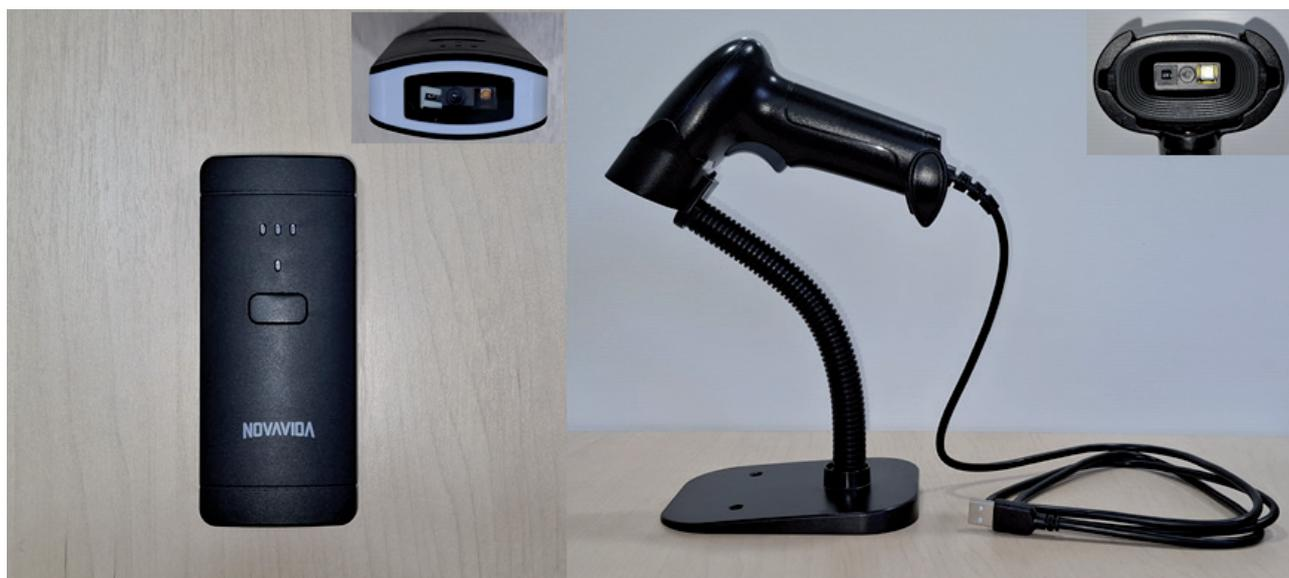
**Figura 3.** Leitores 2D utilizados para avaliar o sistema de QRcodes utilizadas nas biológicas de ninfas e adultos de *Euschistus heros* (Hemiptera: Pentatomidae) em dietas, à esquerda o modelo sem fio com conexão Bluetooth (sensor de 640 x 480 pixels) e a direita o leitor com conexão por porta USB (sensor de 1280 x 800 pixels).
