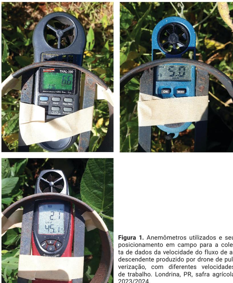
**Figura 1.** Anemômetros utilizados e seu posicionamento em campo para a coleta de dados da velocidade do fluxo de ar descendente produzido por drone de pulverização, com diferentes velocidades de trabalho. Londrina, PR, safra agrícola 2023/2024.
