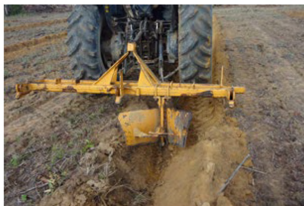
Figura 2. Abertura mecanizada dos sulcos de plantio em Latossolo Amarelo no Campo Experimental do Cerrado da Embrapa Amapá.
