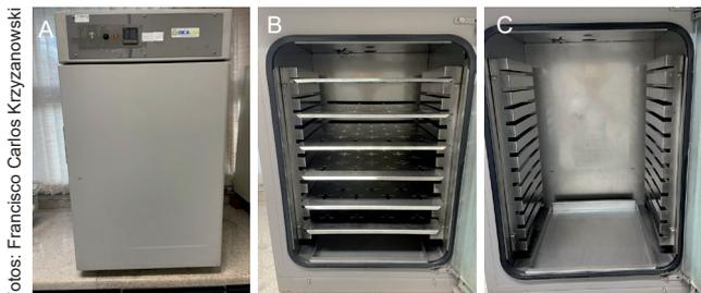
**Figura 9.** Câmara jaquetada de água para condução do teste de envelhecimento acelerado: (A) vista externa; (B) e (C) vistas internas.
