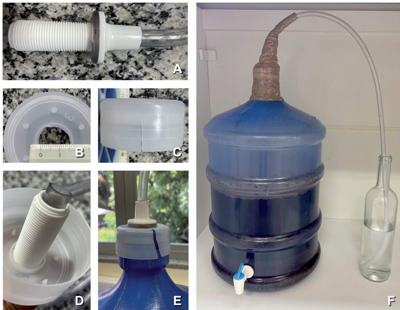
Figura 4. Fermentador artesanal de açai tinto: aparato de acoplamento da mangueira (A); tampa do garrafão furada (B); e cortada (B); aparato acoplado à tampa (D); tampa encaixada no garrafão (E); garrafão com tampa e aparato, devidamente vedado (F).
