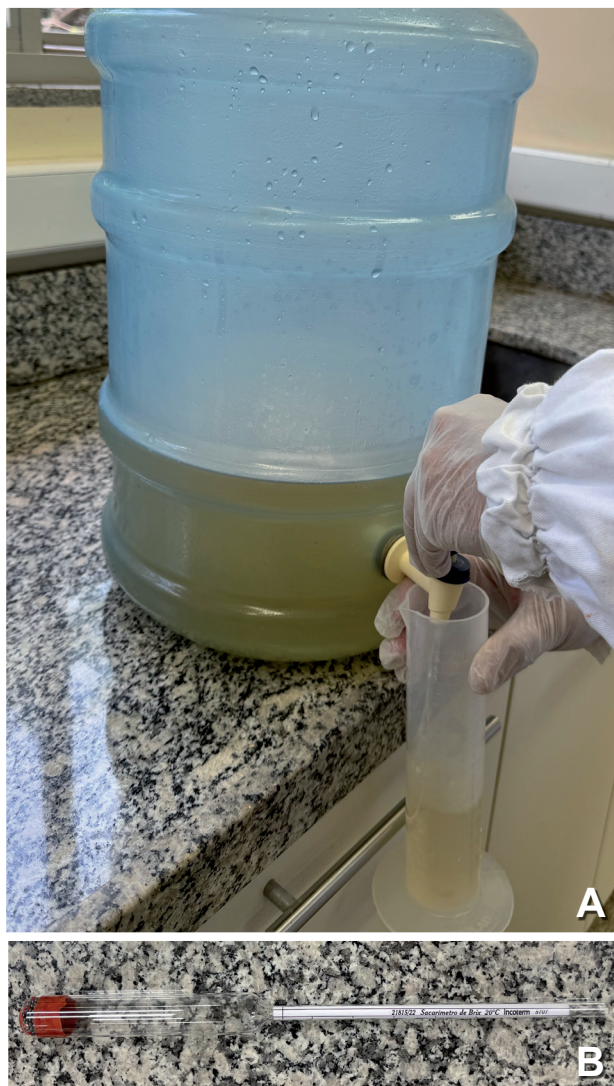
Figura 6. Xarope finalizado e retirada de amostra para leitura do teor de sólidos solúveis (°Brix) (A) com densímetro sacarímetro de Brix (B).
