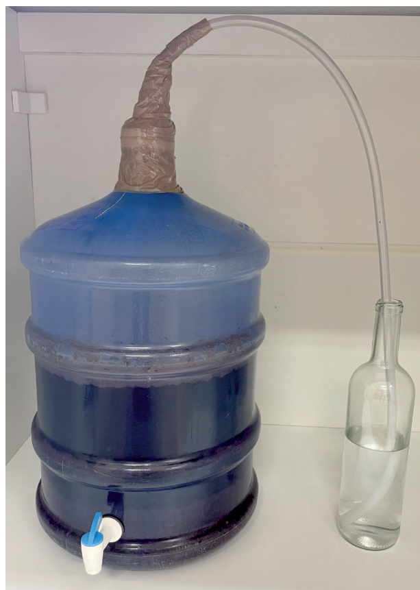
Figura 10. Aparato montado com fermentador acoplado com equipo e garrafa de vidro, em ambiente escuro.
