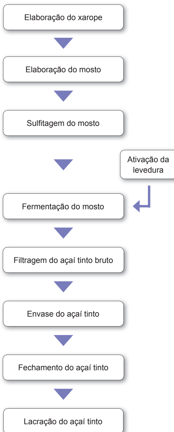
Figura 5. Fluxograma das etapas de elaboração do fermentado alcoólico de açaí.
