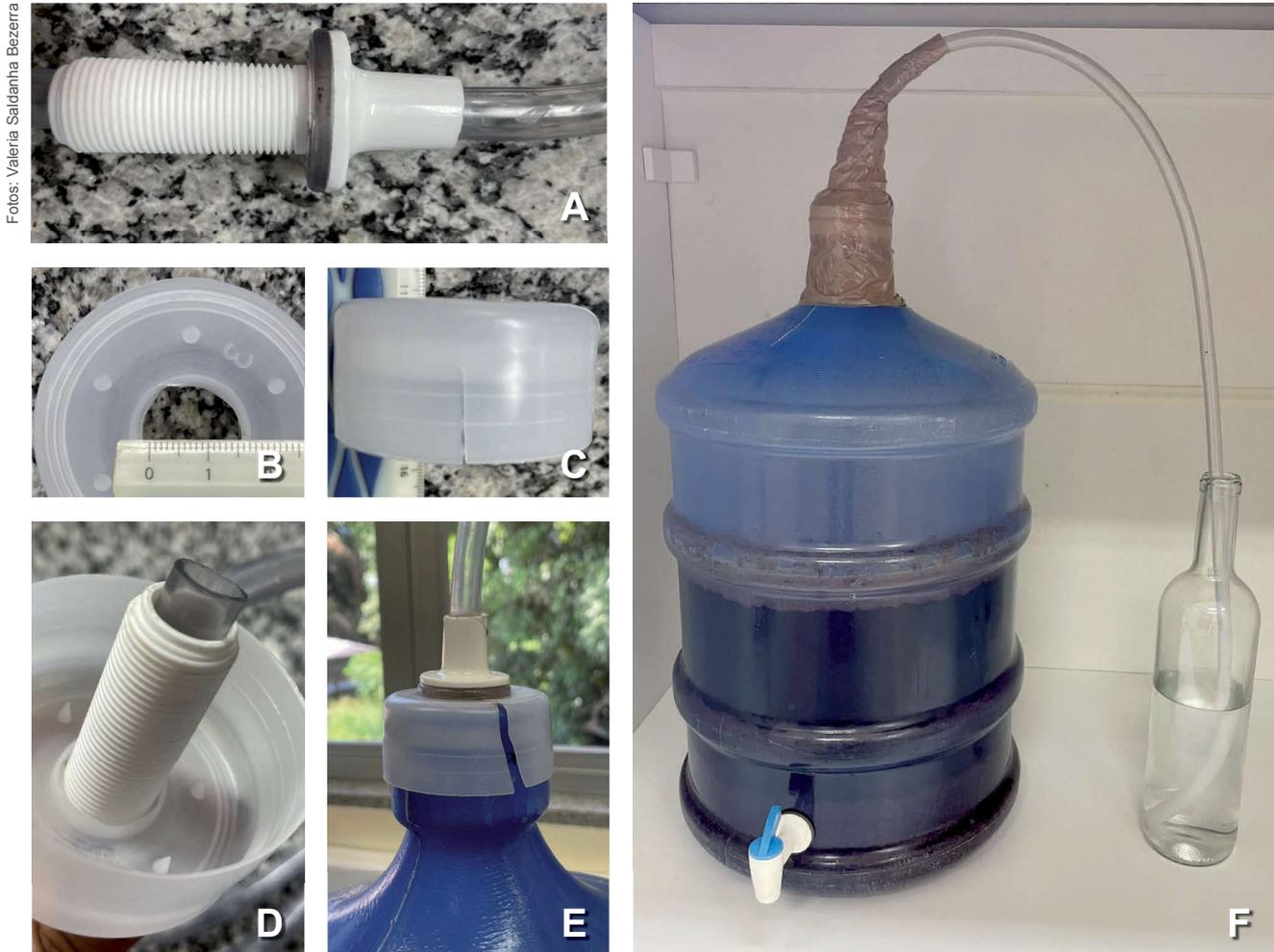
**Figura 4.** Fermentador artesanal de açai tinto: aparato de acoplamento da mangueira (A); tampa do garrafão furada (B); e cortada (B); aparato acoplado à tampa (D); tampa encaixada no garrafão (E); garrafão com tampa e aparato, devidamente vedado (F).
